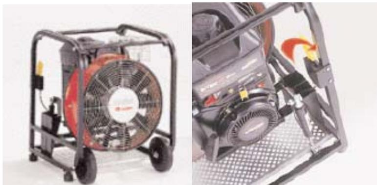
La ventilazione di pressione positiva, il metodo sicuro e rapido per la ventilazione in caso di calore, gas, polvere e fumo. Le ventole ad alte prestazioni sono posizionate all'esterno, e un flusso di aria fresca viene indirizzato all'interno dell'edificio. Il flusso d'aria conico è compresso in ingresso, escludendo in tal modo che si possano verificare riflussi d'aria.
